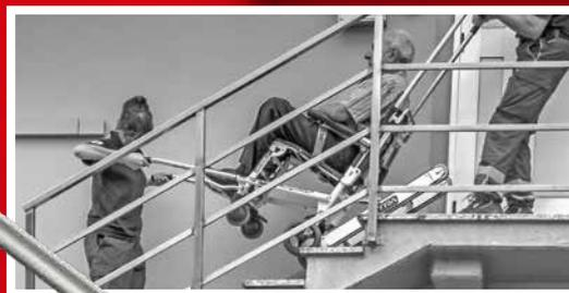
Extra Ergolift è dotata di motore elettrico brushless con riduttore epicicloidale personalizzato appositamente per questo dispositivo.
