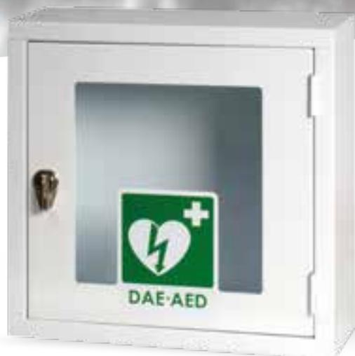
Realizzata in lamiera di acciaio al carbonio P02 zincato; verniciatura a polvere di epossipoliestere RAL9010 bianco; passaggio in galleria termica 180°C. 1 anta finestrata, cerniere con perno zincato, apertura 180°; chiusura a sigillo lucchettabile in zama nichelata; preforata per attacco a parete e su apposita piantana (art. 8432-001).
